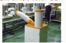
■可動式で、作業スペースをピンポイントで 冷やせます。
